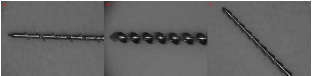
Şekil 7. Şekilde mikroskop altında 25 kat büyütülmüş eğeler, (A) Tirnef, (B) K-tipi eğe ve (C) H-tipi eğe.
